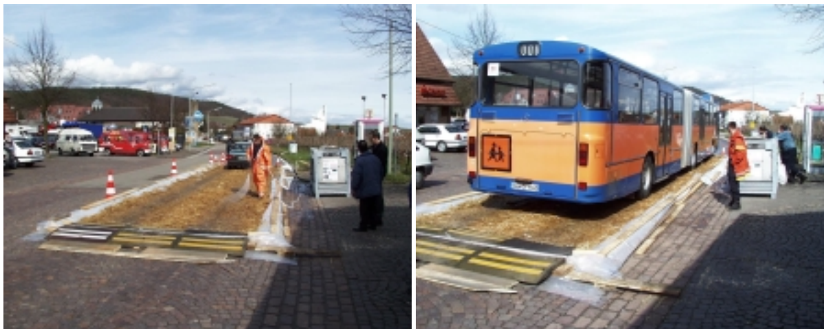
Abb. 2: Teilflächige Fahrzeugdekontamination durch Durchfahren von mit Desinfektionslösungen getränktem Stroh [5]
